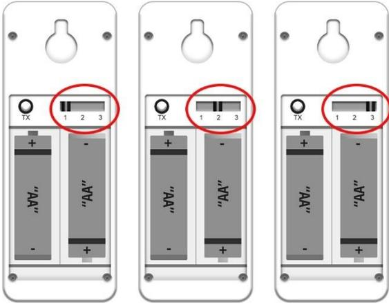
5. Une fois les piles insérées dans les télécommandes, le voyant rouge s'allume. Lorsque le voyant rouge disparaît, les relevés de température et d'humidité de cet émetteur s'affichent sur le moniteur.
